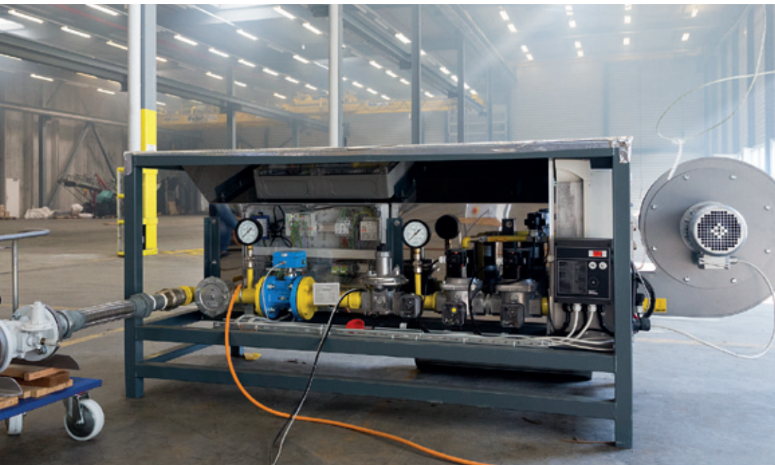
Izar ist mobil und in einer Stunde auf- und abgebaut. Der Warmrauchversuch selber ist in einer Viertelstunde abgeschlossen.
