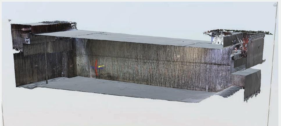
Fig. 5 Durch eine mit mobilem Laserscanner aufgenommene Punktwolke, weiterverarbeitet als Mesh, können beliebige Schnitte gelegt werden.
