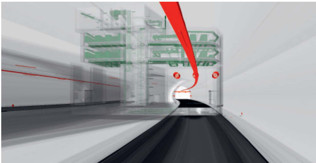
Die drei neuen Zentralen werden als statisches Modell abgebildet, die Tunnelabschnitte hingegen als parametrisches Modell , das sich an der Tunnelachse orientiert.
