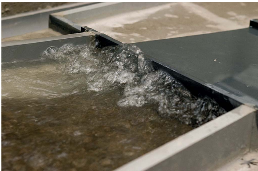
Bild 4. Druckbrücke der SBB-NEAT über den Schächen, Abfluss von 225 m 3 /s im Modell (Quelle VAW).
