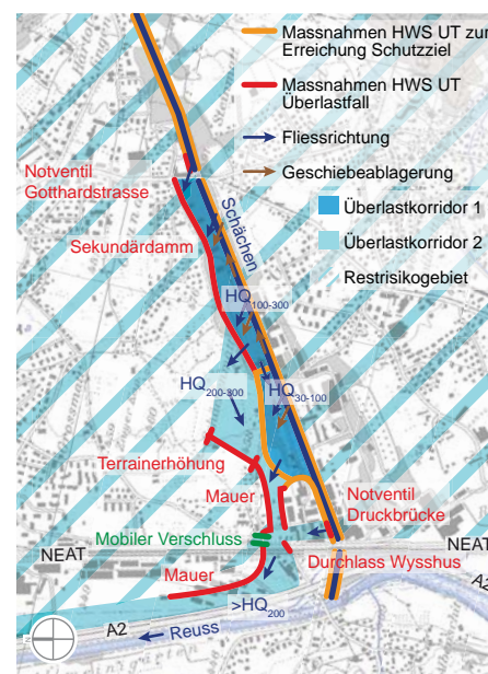
Bild 1. Überlastfall Schächen: Massnahmen und Abfluss- und Geschiebeablagerungsprozess.
