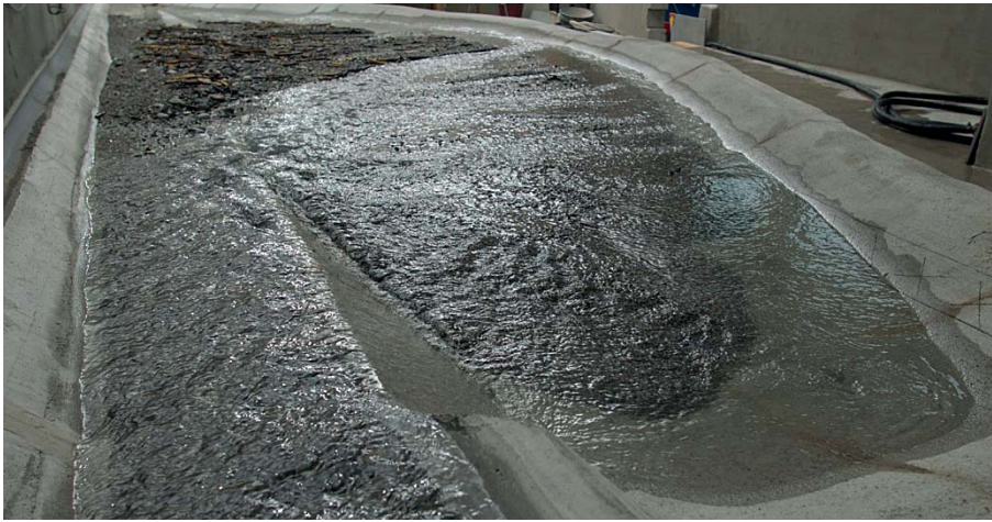
Bild 7. Ansicht in Fließrichtung des Geschiebesammlers und Streichwehrs im physikalischen Modell. Fächerartige Ausbreitung der Ablagerungen im oberen Teil des Sammlers (Quelle: VAW).
