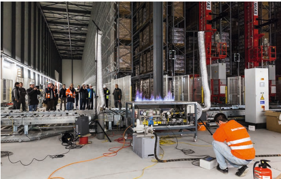
Der Heissrauchversuch im neuen Produktions- und Verteilzentrum von Coop in Schafisheim.
